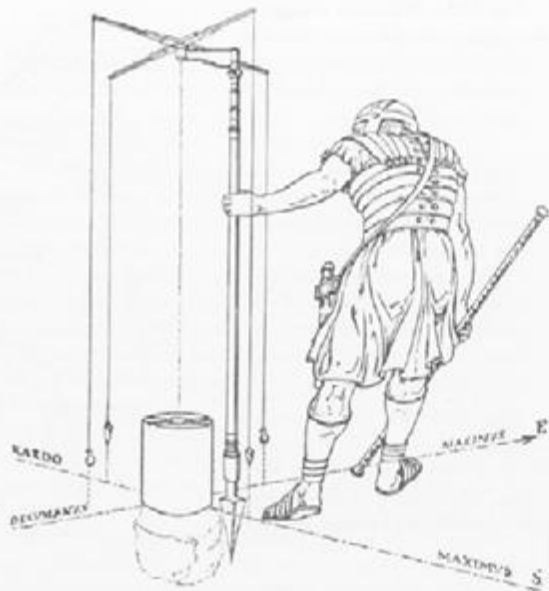
Fig. 331. La «groma», que servía para trazar las alineaciones perpendiculares de la «centuriatio» y de los planos de la ciudad. Estaba formada por cuatro listones de madera, de una longitud aproximada de 45 cm, que sostenían cuatro plomadas; el asta que los sostenía era plantada en el terreno de modo que el centro se encontrara en la vertical del círculo grabado en la piedra.
