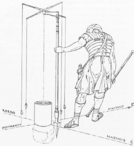
Fig. 331. La «groma», que servía para trazar las alineaciones perpendiculares de la «centuriatio» y de los planos de la ciudad. Estaba formada por cuatro listones de madera, de una longitud aproximada de 45 cm, que sostenían cuatro plomadas; el asta que los sostenía era plantada en el terreno de modo que el centro se encontrara en la vertical del círculo grabado en la piedra.
