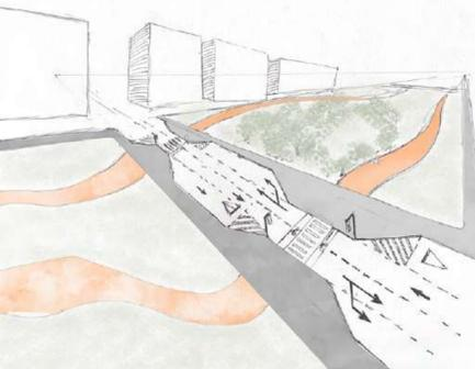
A la izquierda podemos apreciar dos axonómicas; la de arriba nos muestra una vista donde se aprecian las salidas y entradas de la autopista y la inferior nos muestra la reducción de carriles que se aplica para disminuir la velocidad de los vehículos en puntos clave del corredor para generar seguridad a los peatones y poder mantener la continuidad del corredor.
